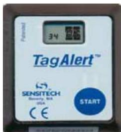
El monitor de temperatura TagAlert® permite controlar la temperatura a la que se exponen los medicamentos durante su transporte; no debe utilizarse para monitorizar la temperatura de almacenamiento en sus cámaras frigoríficas o para monitorizar posteriores envíos del medicamento recibido.
