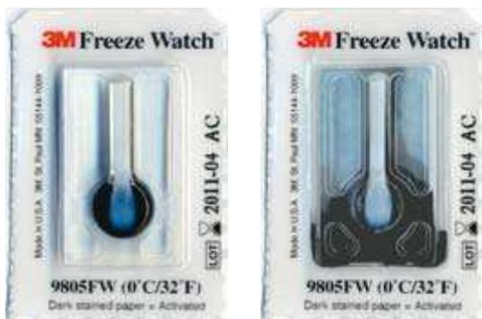
Consiste en un soporte de cartón blanco con un papel de filtro en el que está fijada una ampolla con un líquido de color azul o rojo. Si el indicador se expone a temperaturas inferiores a 0 °C durante más de una hora, la ampolla explota y el papel de filtro se tiñe con el líquido.
